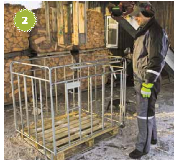
2 Lava on laitettu paikalleen ja etuseinä kiinnitetty, lavasäkki voidaan nyt asettaa telineeseen.
