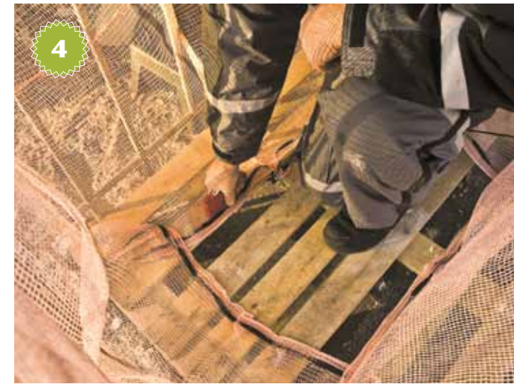
4 Kannattaa varmistaa että lavasäkin alaosa pysyy paikallaan. Jotkut käyttävät pieniä nitojan niittejä, toiset asettavat yksinkertaisesti muutaman klapin telineen nurkkiin.
