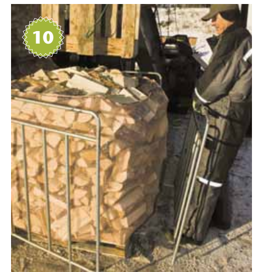
10 Etuseinä on nyt irrotettu ja voidaan nostaa pois.
