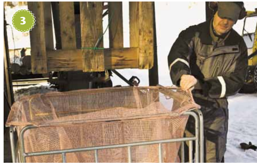
3 Lavasäkki kiinnitetään ensin telineen yläosaan.
