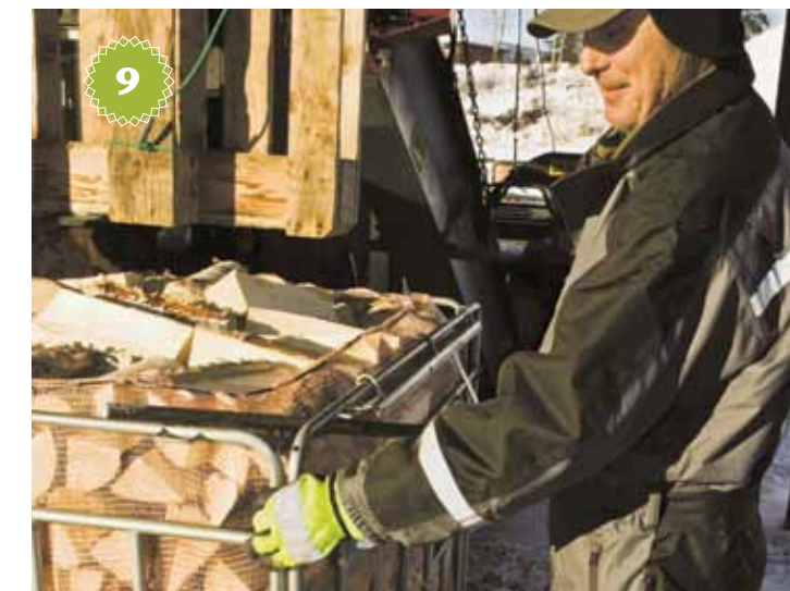
9 Sen jälkeen irrotetaan etuseinä. Joskus klapit voivat painua etuseinää vasten niin, että seinän irrottamiseen pelkin käsin on käytettävä voimaa. Hyvä ratkaisu etuseinän nostamiseen on käyttää rautatankoa vipuna. Silloin ei tarvita niin paljon voimia.
