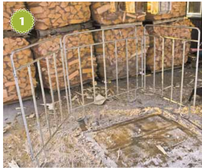
1 Lavasäkin säkitysteline on avattu ja etuseinä irrotettu. Lava voidaan nyt asettaa telineeseen.
