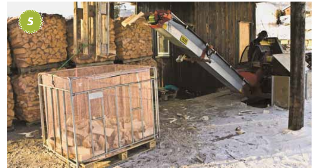
5 Sitten voi aloittaa polttopuiden tuotannon. Tämä klapintekijä on laittanut lavasäkin yläpuolelle esteeksi lavan. Näin hän voi käyttää hihnakuljetinta täydellä nopeudella.
